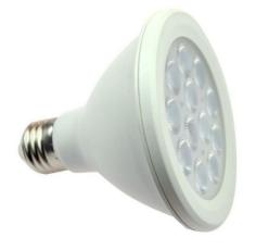
verfügbar. Die Lampe generiert bei 11 Watt Energieverbrauch einen Lichtstrom von ca. 1150 Lumen. Der Farbwiedergabeindex liegt bei einem Spitzenwert von über 95. Die Betriebsspannung (AC) darf zwischen 85 und 265 Volt liegen. (DC: 85 bis 269 V). Der Abstrahlwinkel beträgt 30 Grad und diese Lichtquelle ist auch für den 24-Stundenbetrieb geeignet.
